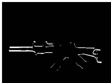
图 2 经过 Canny 算子后轮廓重复和间断
